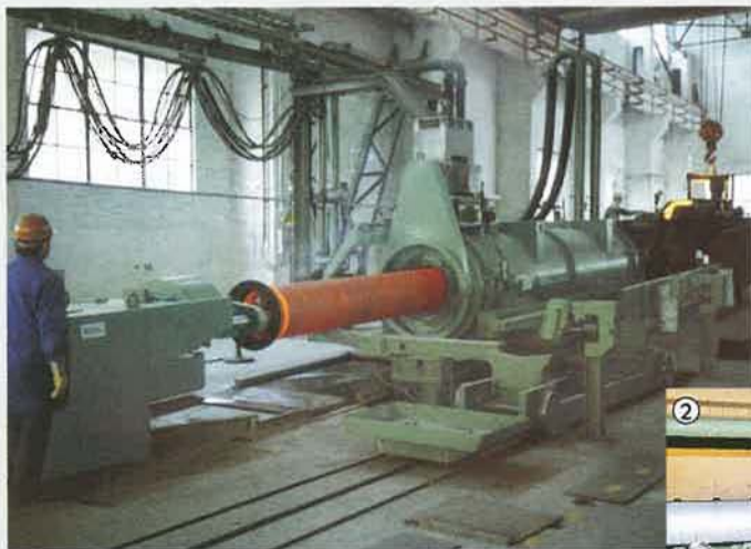
Schleudergießmaschine für duktile GuBrohre NW 400 - 700 mm
