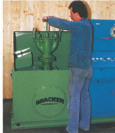
Hydrantenprüfmaschine zur Druckprüfung von Hydranten gemäß DIN 3330, Prüfdruck: 24 bar
