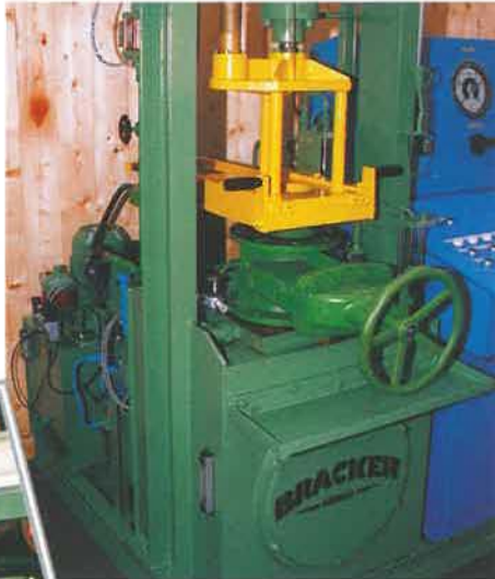
Schieberprüfpresse für Gehäuse- und Dichtigkeits- prüfungen, für Nennweite 65 - 150mm u. 200 - 300mm
